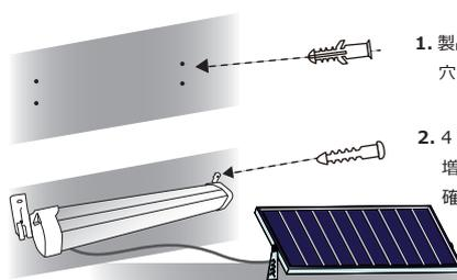
1. 製品本体の固定用の穴に合わせて、設置面の箇所にも穴を開け、樹脂アンカーを挿入してください。
