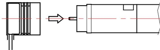
2. 接続は、不完全挿入とならないように、隙間なく挿入する
