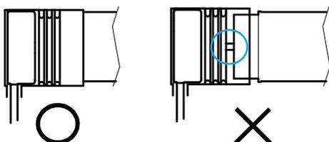
3. LED蛍光灯を縦配置する場合、防水ソケットは必ず上部に接続する
